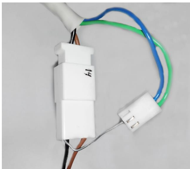
Рис.9а – Подключение сигнала управления (ШИМ) двигателя для проверки.
